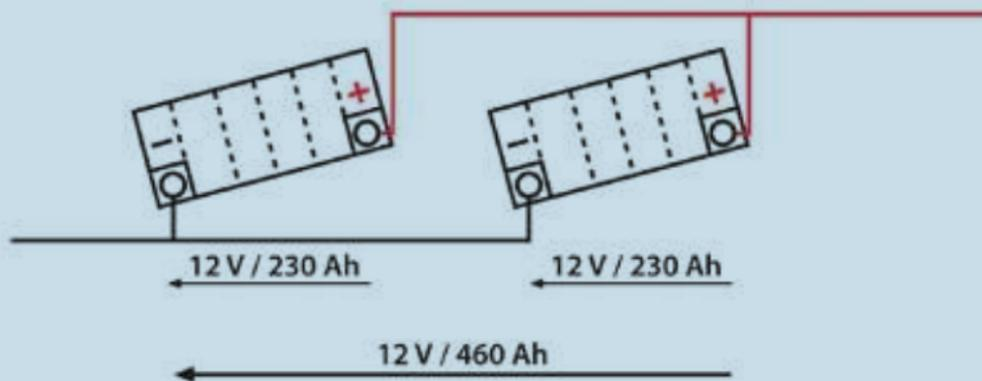
Dans un montage parallèle, les capacités individuelles ainsi que les courants de démarrage à froid des différentes batteries s'additionnent.
