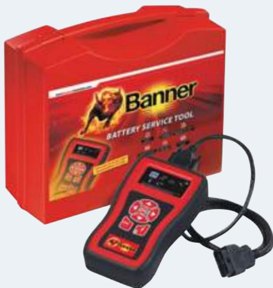
Le Banner Battery Service Tool (BBST) est idéal pour le remplacement des batteries dans les véhicules équipés d'un système de gestion de batterie. Cet appareil très pratique, en plus de vous indiquer la batterie de rechange adaptée, peut également supprimer les codes d'erreur spécifiques au fabricant et intégrer la nouvelle batterie dans le système du véhicule.
