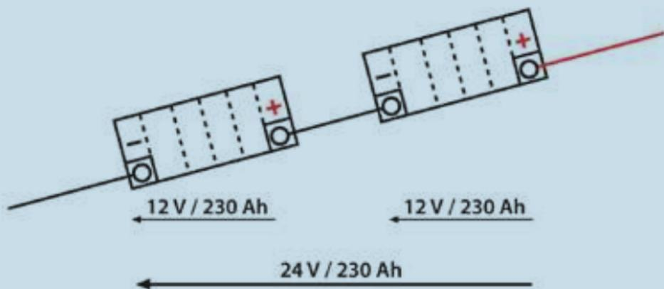
Dans un montage en série (= couplage en série), les tensions de chacune des batteries s'additionnent. Pour avoir un réseau de bord de 24 V, deux batteries de 12 V doivent être montées en série.
