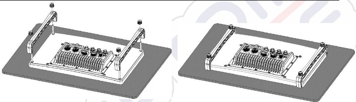
4. Notez qu'un espace supplémentaire doit être prévu derrière un NavX en raison du rayon de courbure minimum des câbles.
