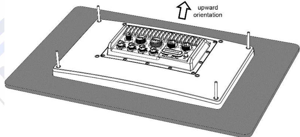
3. Fixez les supports (fournis avec l'appareil) à l'aide de goujons filetés et d'écrous à ailettes. Les écrous doivent être serrés avec précaution à la main pour éviter qu'ils ne se desserrent sous l'effet des vibrations, tout en veillant à ne pas endommager le NavX par un serrage excessif.
