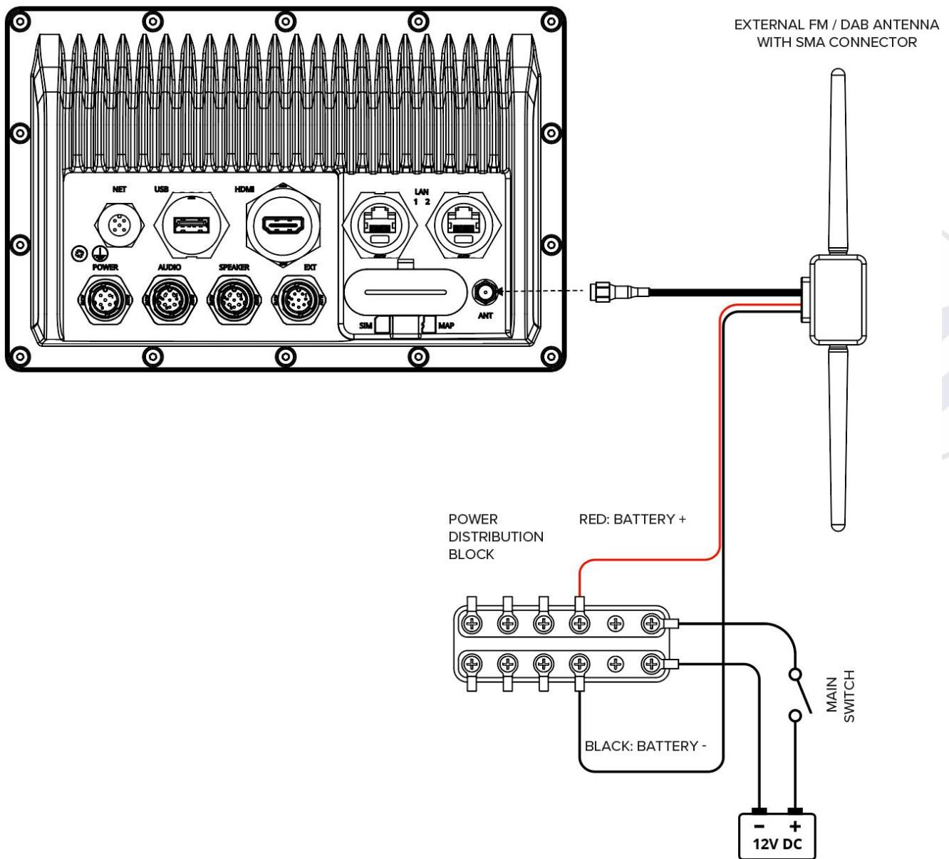
Connectez l'antenne FM/DAB (fournie séparément) au connecteur ANT du NavX. Vous pouvez utiliser une antenne FM/DAB avec un connecteur SMA, ou vous pouvez utiliser un câble adaptateur SMA mâle vers DIN femelle et connecter toute antenne FM/DAB avec un connecteur DIN mâle au câble adaptateur.
