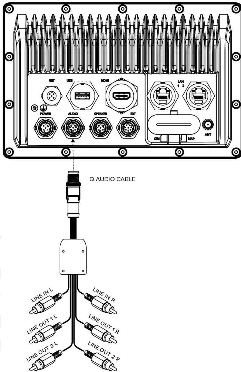
LINE IN peut être utilisée comme entrée auxiliaire, sélectionnable comme source dans l'application Musique.
